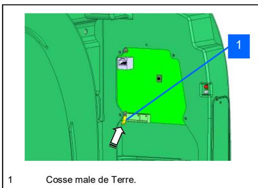
• Maintenez fermement le câble de Terre sur la colonnette métallique à l'aide du serre câble.
